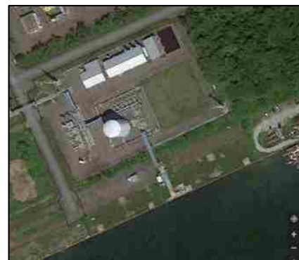
勇払LNG受入基地概要(北海道苫小牧市) LNG受入設備：内航船バース(4,800m 3 級) LNG貯蔵設備：LNGタンク(2,700kL)×1基 敷地面積：21,000m 2
