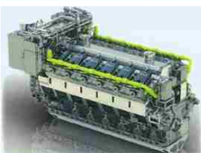
宮古デュアルフューエルエンジンの概要 (宮古第二発電所 #6,#7)
